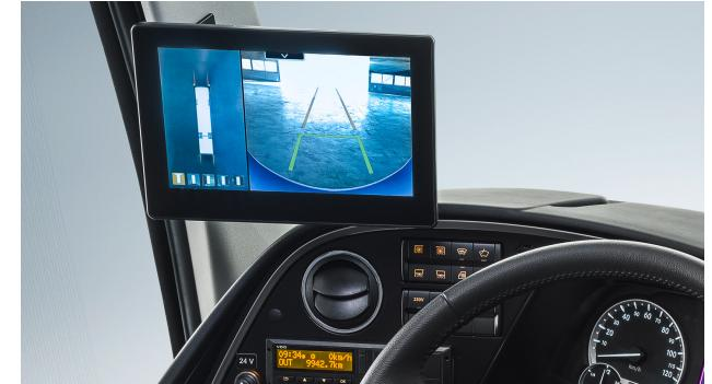
Le système de caméra 360° est composé de quatre caméras qui filment l'environnement immédiat du véhicule et génèrent une vision périphérique indirecte. L'écran 10" associé se trouve dans le montant A au dessus du poste de conduite. Ce système permet de visualiser les piétons, cyclistes et obstacles présents dans la zone et que le conducteur ne verrait pas sans cela. Ce système améliore la sécurité du trafic en détectant les risques de collision, et en les évitant dans le meilleur des cas.
