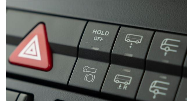
Le frein électrique avec fonction Hold allie une manipulation facilitée à plus de confort et de sécurité. Quand le véhicule est immobilisé, il est retenu par le frein de service lorsque la pédale de frein est actionnée au-delà d'un certain point ; au démarrage, le frein est à nouveau automatiquement desserré. La fonction est désactivable par un bouton.
