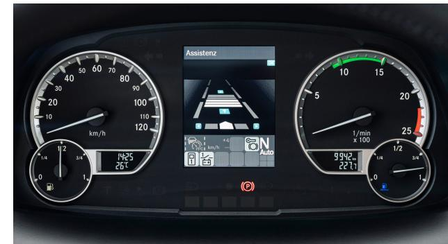
L'Active Drive Assist 2 assiste activement le conducteur en associant différents systèmes d'assistance pour réguler les distances et la trajectoire. Le système permet de freiner et d'accélérer le véhicule et aussi de le maintenir sur sa voie en intervenant proactivement sur la direction. Pour y parvenir, il relie les fonctions des différents systèmes d'une façon propre qui permet aujourd'hui déjà une conduite partiellement automatisée sur toutes les plages de vitesse.
