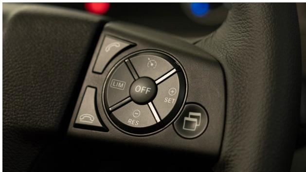
Le régulateur adaptatif de vitesse et de distance (ART) avec Active Brake Assist 6 (ABA 6) soulage le conducteur en maintenant automatiquement une distance constante définie par le conducteur par rapport au véhicule qui précède, sur la base de mesures effectuées en continu. L'ABA 6 assiste en plus le conducteur en cas de collision imminente avec des objets fixes ou mobiles et des piétons en mouvement.
