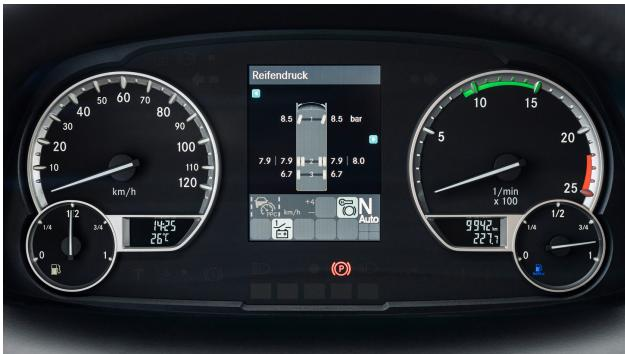
Une pression correcte des pneus contribue à la sécurité de conduite et à une réduction sensible de la consommation en carburant. Une pression des pneus trop basse de seulement 0,5 bar peut déjà générer une hausse de la consommation de carburant pouvant s'élever jusqu'à 5 %. L'électronique de roue est positionnée à chaque fois en face intérieure de la jante sur la valve. Les capteurs saisissent les données requises pour établir la pression des pneus et les transmettent à l'instrument d'affichage.
