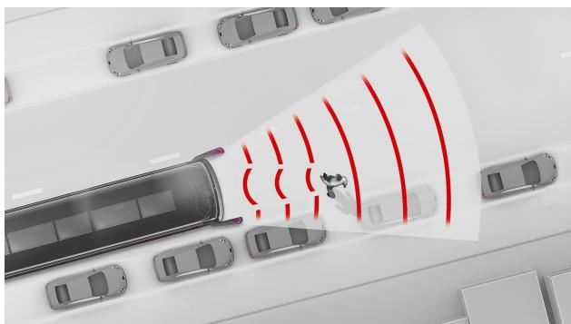
Il sistema di assistenza alla frenata di emergenza ABA 6 supporta il conducente con una frenata di emergenza avviata automaticamente in caso di pericolo imminente di tamponamento contro veicoli che precedono o ostacoli fermi. Riconosce anche le persone e i ciclisti in movimento o che si fermano davanti al veicolo. Il sistema reagisce attivando una segnalazione acustica e visiva al conducente e avviando automaticamente una frenata parziale o una frenata a fondo.
