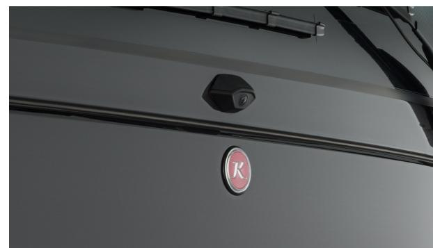
Il sistema di videocamera a 360° si compone di quattro videocamere che rilevano l'area immediatamente circostante il veicolo producendo una vista
