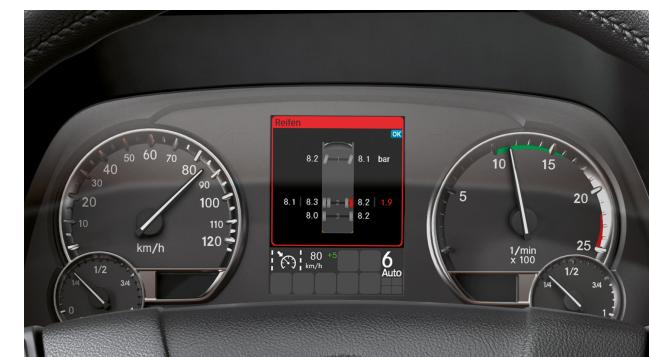
Il controllo senza fili della pressione degli pneumatici con visualizzazione sul display multifunzionale è un sistema elettronico di sicurezza che controlla in modo permanente la pressione di tutti gli pneumatici. Le perdite di pressione degli pneumatici vengono visualizzate nel quadro entro i limiti del sistema.
