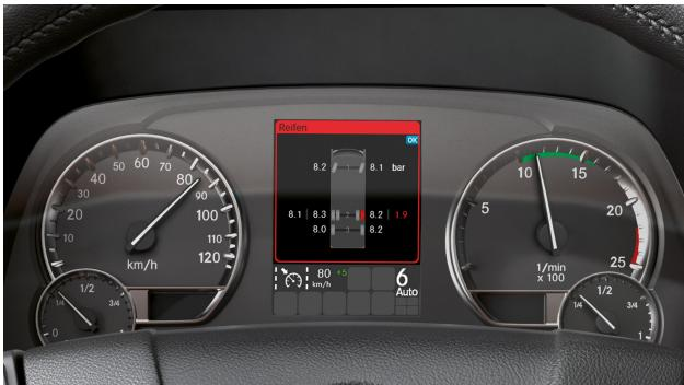
Le contrôle sans fil de la pression des pneus avec affichage à l'écran multifonction est un système de sécurité électronique qui contrôle en permanence la pression d'air de tous les pneus. Dans les limites du système, les pertes de pression des pneus sont affichées.
