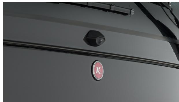
Das 360°-Kamera-System besteht aus vier Kameras, welche die unmittelbare Fahrzeugumgebung erfassen und eine
