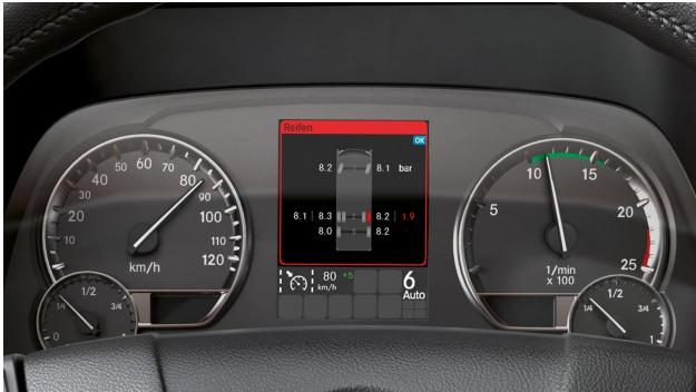
Das drahtlose Reifendruckkontrollsystem mit Anzeige im Multifunktionsdisplay ist ein elektronisches Sicherheitssystem, das den Fülldruck aller Reifen permanent kontrolliert. Reifendruckverluste werden im Rahmen der Systemgrenzen angezeigt.
