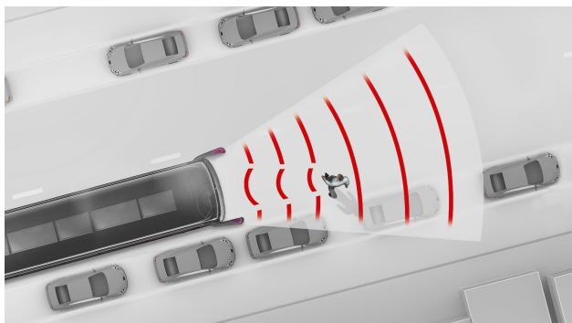
Der Notbremsassistent ABA 6 unterstützt den Fahrer durch eine automatisch eingeleitete Notbremsung bei drohender Gefahr von Auffahrunfällen auf vorausfahrende Fahrzeuge oder auf stehende Hindernisse. Er kann ebenfalls sich bewegende oder stehenbleibende Personen und Fahrradfahrer vor dem Fahrzeug erkennen. Das System kann darauf mit einer akustischen und optischen Warnung des Fahrers sowie einer automatisch eingeleiteten Teilbremsung bzw. einer Vollbremsung reagieren.
