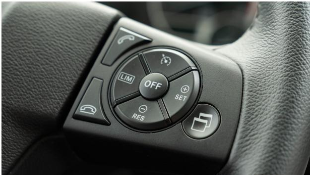
L'Adaptive Cruise Control (ACC) con Active Brake Assist 6 (ABA 6) allevia il conducente dalle inutili sollecitazioni associate al mantenimento di una distanza costante dal veicolo che precede, con una misurazione continua. Inoltre, L'ABA 6 supporta il conducente in caso di collisione imminente con oggetti fermi, oggetti in movimento e pedoni in movimento.
