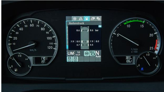
La corretta pressione degli pneumatici comporta la sicurezza di guida e una riduzione sensibile del consumo di carburante. Già una pressione impostata di 0,5 bar troppo bassa può far aumentare il consumo di carburante di circa il 5%. L'elettronica è posizionata nella parte interna del cerchione sulla valvola. I sensori rilevano i dati relativi per la pressione degli pneumatici e li inoltrano alla strumentazione di visualizzazione.
