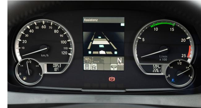
Grazie ad un sistema a videocamera posizionato dietro al parabrezza, l'assistente mantenimento corsia SPA rileva quando il veicolo devia accidentalmente dalla traiettoria. Non appena il veicolo supera la linea di demarcazione, il conducente viene avvisato con una vibrazione sul sedile del conducente.
